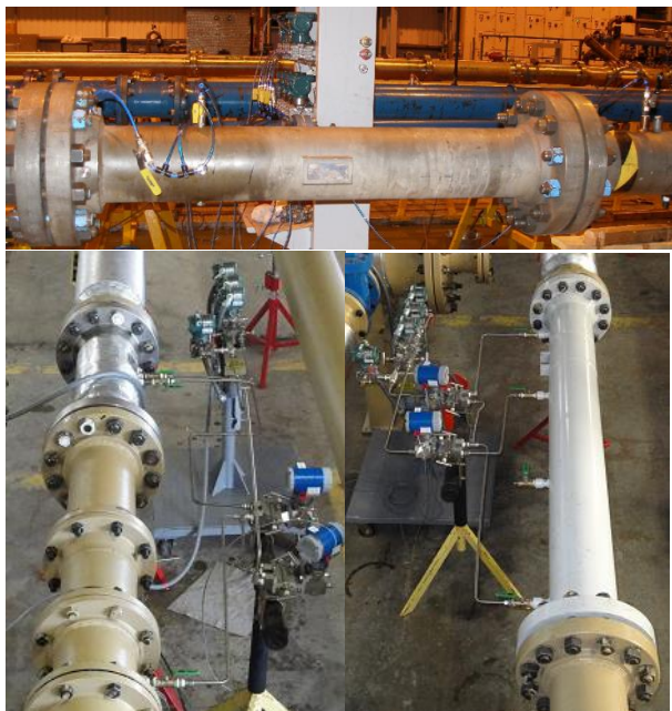
Fig 1. Clockwise from top, NEL 8" Venturi meter, & CEESI 8" wedge meter & 8" cone meter.
